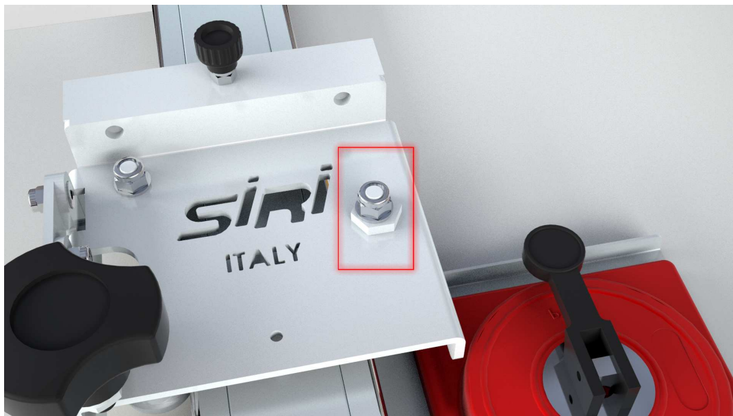
Abb. 6.4.1 Einstellschraube zwischen Führung und Siricut.
